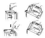
**8a** To pour out thinner mixtures, ensure the lid is locked in place, then open the pour spout cap.
