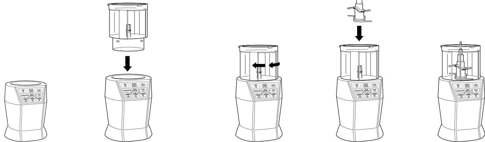
**1** Placez le socle moteur débranché sur une surface plane, propre et sèche comme un comptoir ou une table. Poussez sur le socle moteur pour faire adhérer les ventouses à la surface de travail. Veillez à ce que le socle moteur soit connecté à la prise du secteur.
