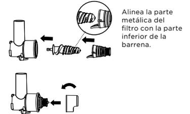
Alinea la parte metálica del filtro con la parte inferior de la barrena.
